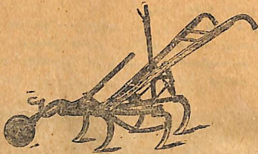
Նկ. 16. Բամբակի սերմնացանի բարձրացրած դիսկավոր փոցի:
