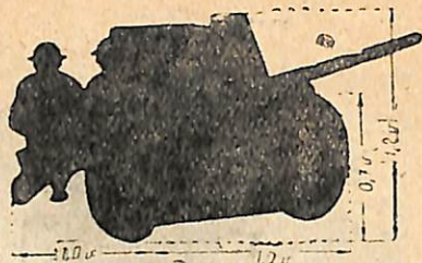
№ 23b—հակատանկային հրանոթ և լրացուցիչ կերպով յերեք ֆի- զուր՝ 2,5 մ հակատով և 3 մ խո- րուք յամբ
