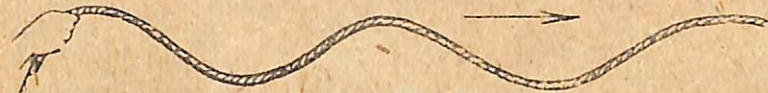
Նկ. 2. Պարանի վրա առաջացած ալիքները: Սլաքով ցույց է արված ալիքների շարժման ուղղությունը:
