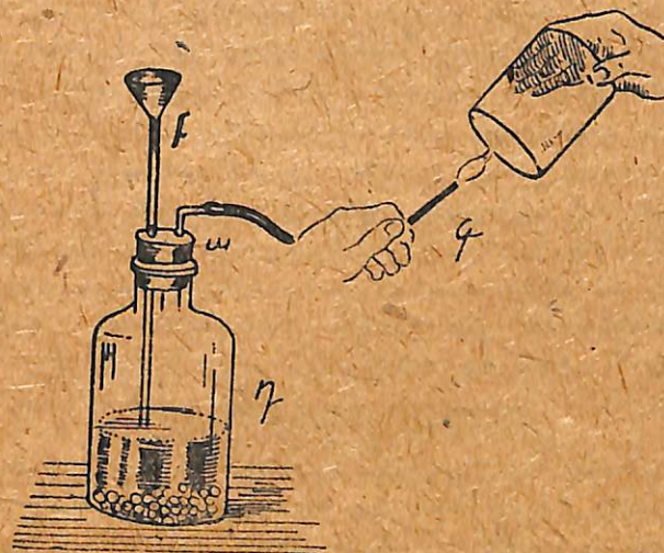
Նկ. 4 Զրածին գաղի վրա պահող սառը բաժակի պատերի վրա նստում են ջրի կաթիլներ:
