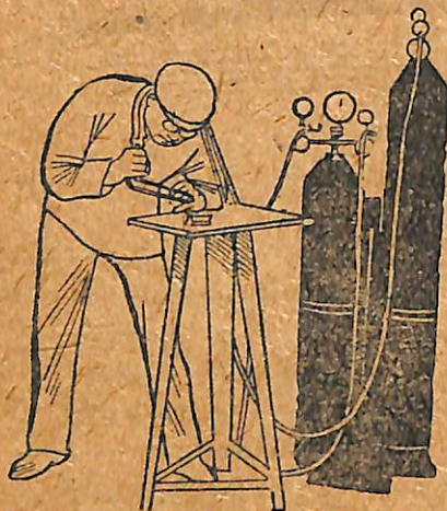
Նկ. 7 Ջրածնա-թթվածնային բոցով կտրում են յերկաթե տախտակը:
