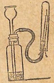
Նկ. 36 Փորձանոթի մեջ ջրածնի լցվելը: Ջրածինը դուրս է մղում ողը՝ շրջած փորձանոթից:
