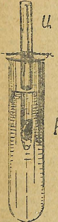
Նկ. 6. Ամուր նյութերի լուծելիությունը հետազոտելու գործիք:
