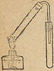
Նկ. 85. Պղնձսուլֆի վերականգնումն անխաղ:
