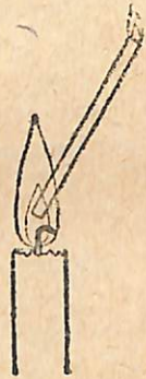
Նկ. 68. Չոր բորման պրոպուլաններ մոմի բոցից դուրս բերելը:
