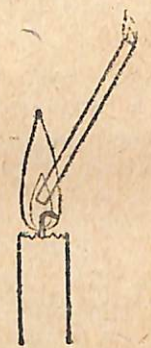
Նկ. 68. Չոր բորման պրոդուկտներ մոմի բոցից դուրս բերելը:
