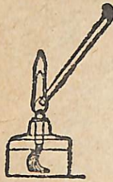
Նկ. 67. Սպիրտային բոցից սպիրտի գոլորշիներ դուրս բերելը:
