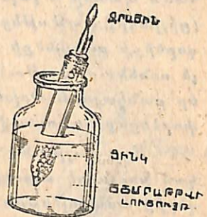
Նկ. 61. Գործիք՝ ջրածին ստանալու համար:
