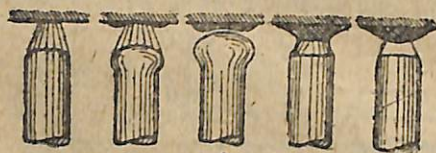
Նկ. 60. գնդիկի տեղափոխվելը առաստաղային յեռի ժամանակ
