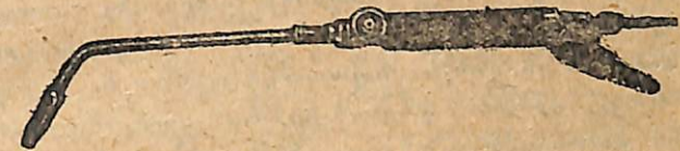
Նկ. 32. «Գրիսսեյմ Ելեկտրոն» այրիչ՝ լուծված աղետիլենի համար
