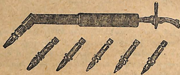
Նկ. 30 Բարձր ճնշման գազերով աշխատող «Դրագերվերկե» այրիչ:
