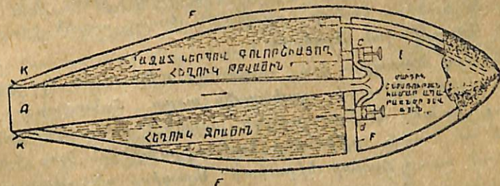
«հեղուկային» հրթիռի կտրվածքն ըստ Կ. Ն. Յիուլիովսկու
