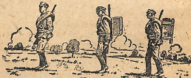
Նկար 19. Գումարտակային ռադիոկայանը յերթի ժամանակ: Առաջիկայի գնում է ռադիոկայանի պետը, նրա հետևից՝ յերկու ռադիոհաղորդիչ: մեկն ընդունող-հաղորդիչ փաթեթով, իսկ մյուսը՝ սնման փաթեթով:
