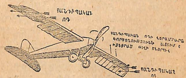
Նկ. 13. Ելերոնների գործողությունը: Յերբ աջակողմյան ելերոնը բարձրացած է, իսկ ձախակողմյանը իջեցրած, ապա հանդիպական ողի ճնշումը (այդ ցույց է արված սլաքներով) ձախ ելերոնի վրա ավելի մեծ կլնել, քան աջը վրա, դրա հետևանքով ձախ թևը կբարձրանա, իսկ աջը կիջնի:
