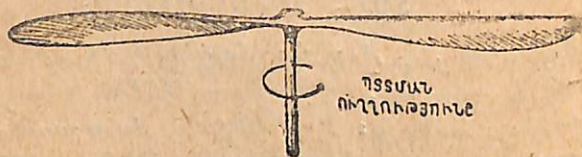
Նկ. 3 «Ճանճ» — ամենապարզ ողային պտուտակը: Նկարի վրա ձողը փոքրացրած է: Վորակցողն «ճանճը» թռչի, պետք է, վոր ձողիկը թաթերի ընդհանուր յերկարությունից փոքր չլինի:
