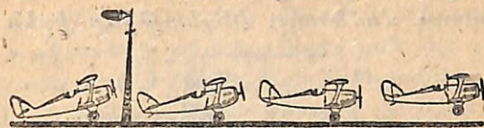
Նկ. 30. Ինքնաթիռի վերաթռիչքը: Նկարի վրա ցույց ե տրված թե դեկավարման բռնակը և խորության դեկը հաջորդաբար ինչ դիրքեր են ընդունում վերաթռիչքի ժամանակ:
