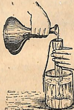
Նկ. 40. Հեղուկները իրենց վերև գործ դրած ճնշումը դուրս տալու հասարակ փորձ:
