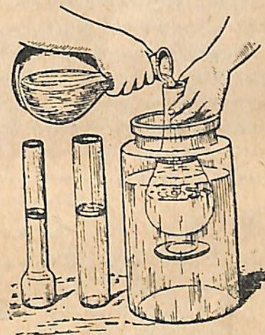
Նկ. 41. Հեղուկի ճնշումը անոթի հատակի վրա կախված է միայն հասակի մակերեսից և հեղուկի մակերեսի վրայի բարձրությունից: Նկարի վրա ցույց է տրված, ինչպես պետք է ստուգել այդ կանոնը:
