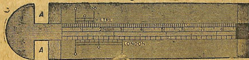
Նկ. 12. Պարզ շտանգենցիբիլություն: Չափվող մարմինը դրվում է A մասում յեվ սեղմվում
