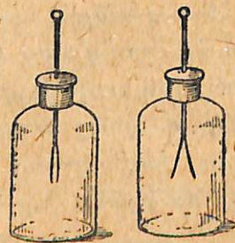
Նկ. 40. Ելեկտրականացած և վոչ ելեկտրականացած ելեկտրոսկոպներ:
