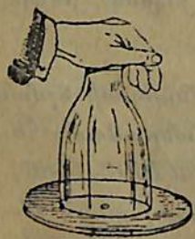
նկ. 59. Մթնուորտի ճնշման գոյությունը հաստատող փորձը:
