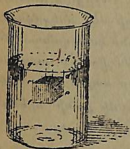
Նկ. 60. Խորանարդը դուրս և նրվում ներքևից դեպի վերև ուղղված ուժով:
