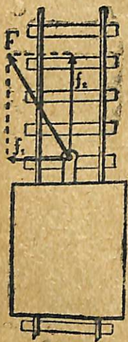
Նկ. 45. Չիու քաշող F ուժը վեր է լուծվում f_1 և f_2 ուժերի:
