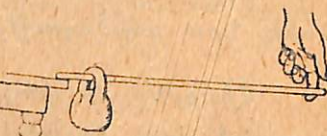
Նկ. 47. Ծանրությունը ազդում է դեպի ցած, իսկ ձեռքի ուժը՝ դեպի վեր: Առաջին նկարի մեջ հավասարակշռություն ստացվում է մեծ ուժով, իսկ յերկրորդի մեջ՝ փոքր:
