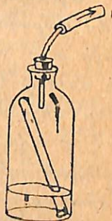
Նկ. 118. Յերբ անոթի ողը հանում ենք, փորձանոթի մեջ գտնվող ողն սկսում է բնդարձակվել:
