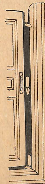
Նկ. 38. Մոմերի բոցը տաքերը բարեխառնութիւն ունեցող սենյակներէ միջև թեքվում է:
