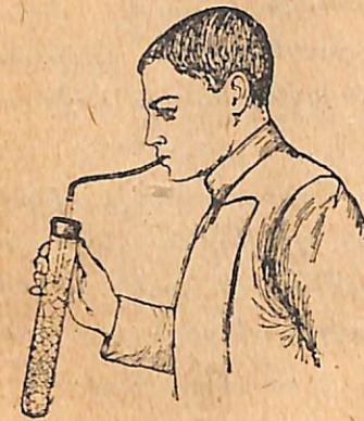
Նկ. 7. Բերանով փոփոխում ենք ողի ճնշումը և դրա հետևանքով փոփոխվում է սապոնի փրփուրի ծավալը:
