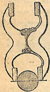
Նկ. 13. Չափումը սահմանային տրա- մաչափով: Ստա- նային ճարմանդ:
