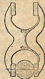
Նկ. 12. Չափումը սահմանային տրամաչափով: Միջանցիկ ճարմանդ:
