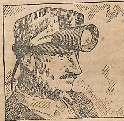
Նկ. 40. Հանքափորի գլխարկին ամրացրած ելեկտրական լամպը:
