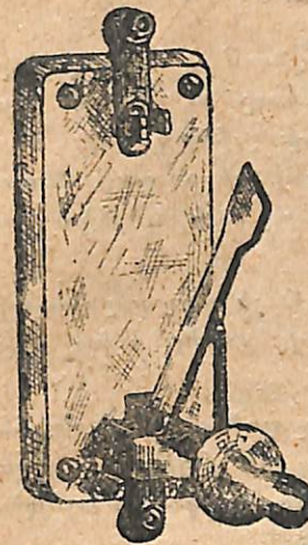
Նկ. 17. Միաբեկ հատոց: Այս տնջատիչը կտրում է միայն այն լարն հոսանքը, վորն աղբյուրից գնում է դեպի գործիքը:
