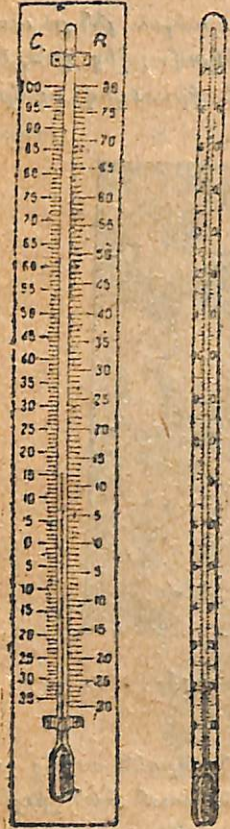
Նկ. 4. Չերմաչափ: Ուշադրություն դարձրեք ձախ Չերմաչափի վրա նա յերկու ցուցման ունի, ձախից՝ C, աջից՝ R:
