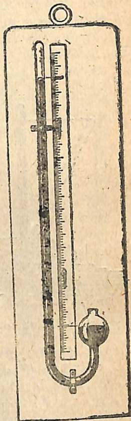
Նկ. 79. Բաթա-վումի դեպի վեր: Այսպիսով Նկ. 80. Միֆոնաձև բա- կավոր բարոմետր: ճնշումը մեծանալիս տուփի խուփը կկորանա, իսկ փոք-
