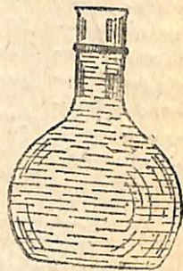
Նկ. 16. Ողակով նշա- նակված և որվակի մեջ ամած հեղուկի մակարդակը:
