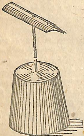
Նկ. 1. Փրշածայրից պատրաստած ինքնաշեն մագնիսական սլաք:
