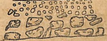
Պատկեր 36 ճանապարհի հիմքը կարող է ծառայում վորպես հիմք կառուցվիլիք ճանապարհի կեղևի համար:
