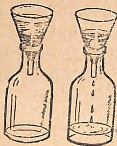
Նկ. 4. Ինչպես ե- ջուրն անցնում կա- վի և ավազի միջով: Աջ կողմը կավի փորձը, ձախ կողմը՝ ավազի:
